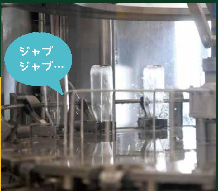
ジュースを詰める前に、リンサーという機械で瓶の内側の洗浄を行っています。瓶はキレイに造られてきたのですが、念のため再度洗浄します。
