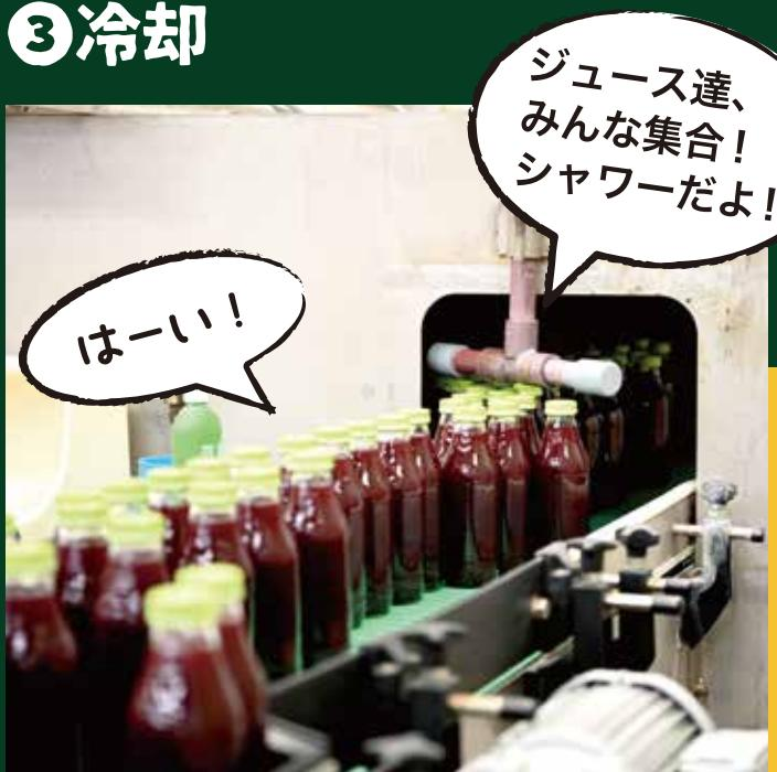
水を吹きかけながら、高温の瓶を段階的に冷却していきます。
